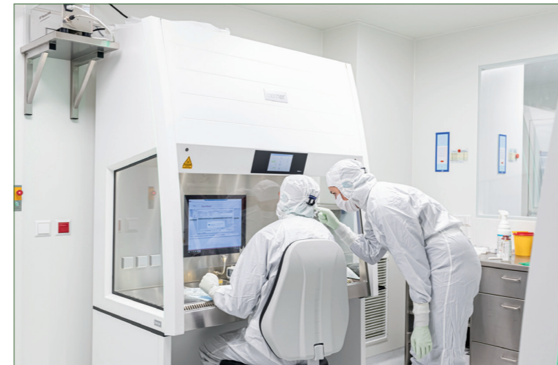
Herstellung Klasse A (Sicherheitswerkbank) in einem Raum Klasse B im Vieraugenprinzip, Foto: eric-kemnitz.com
